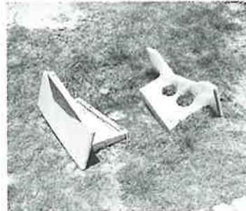
割られた照明保護材
