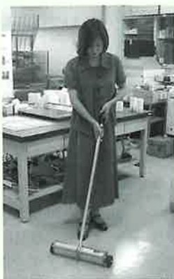
■工場の鉄粉を集める 「磁石掃除機」
