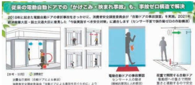
▲災害対策型・荷重式自動ドア（無電源）を採用し持続可能な開発目標を推進し、ドアに挟まれる事故はなく、災害時にも手動で開閉できる構造となっています。
